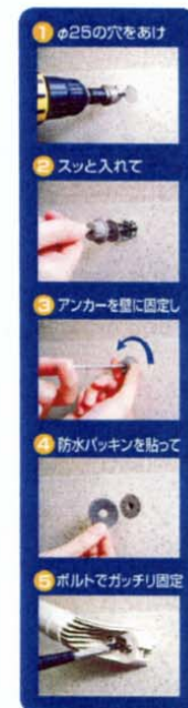
壁裏イメージ写真 (TQアンカー固定図)
